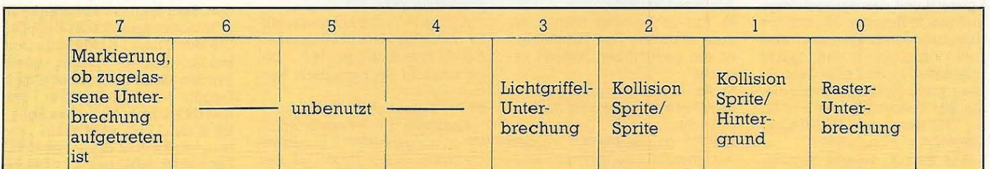
Bild 4. Das Interrupt-Latch-Register (53273 = $d019) des VIC-II-Chip
